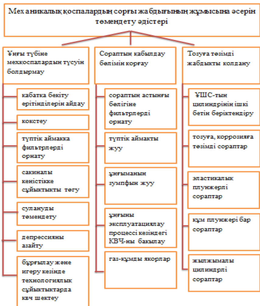
1.18 Сурет – Ұңғыма ішіндегі жабдықтарды механикалық қоспалардан қорғау әдістерінің құрылымдық сұлбасы
