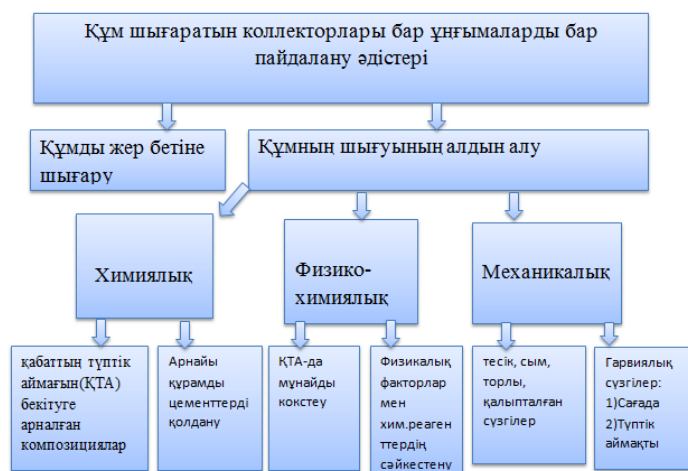
1.12 Сурет – Құм бөліну жағдайындағы коллекторлардан ұңғымаларды пайдаланудың негізгі әдістері
